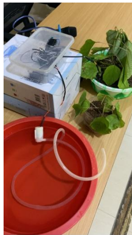
Gambar 5. Alat penyiraman otomatis berbasis sensor soil moisture .
